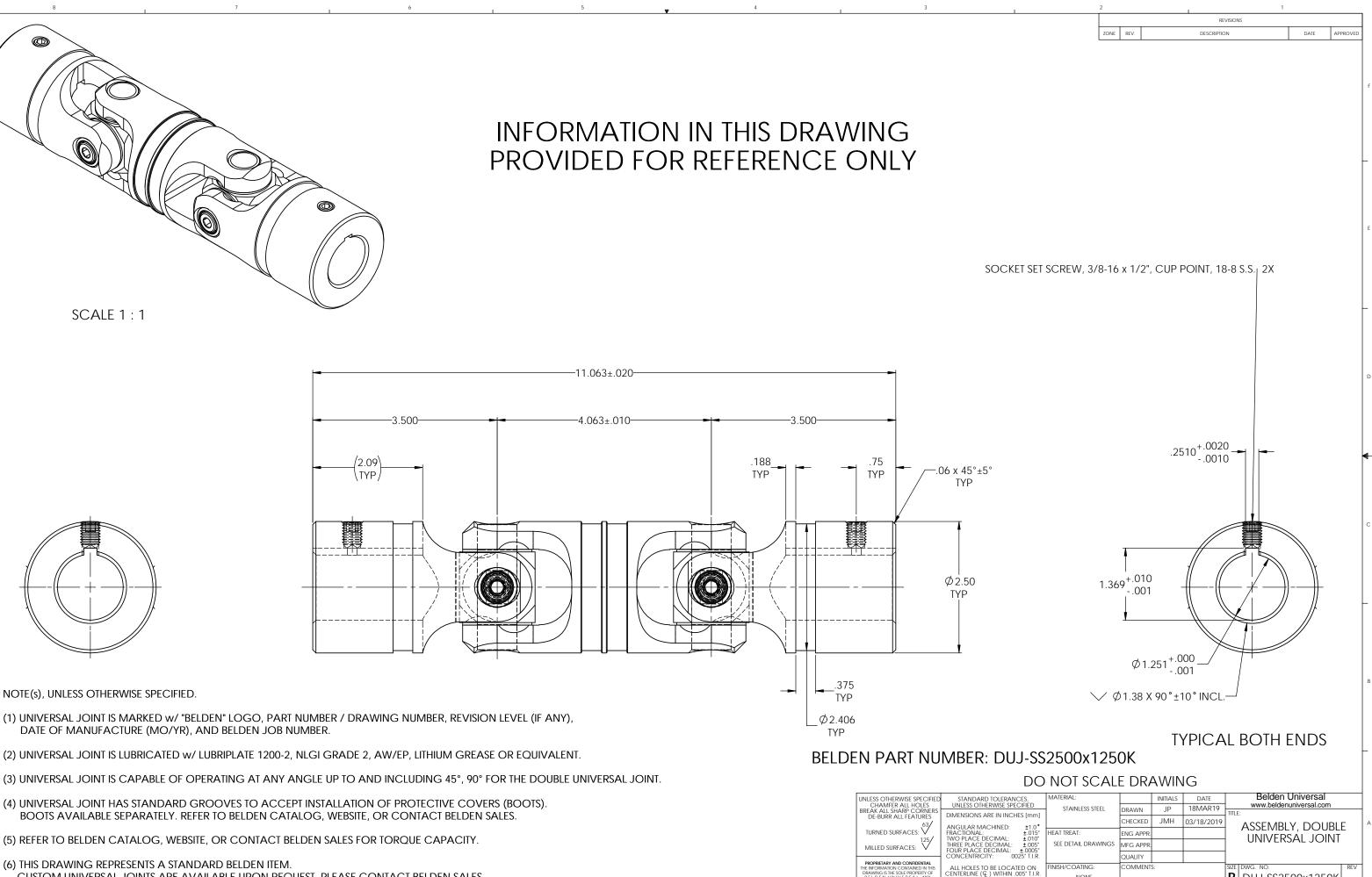
(3) UNIVERSAL JOINT IS CAPABLE OF OPERATING AT ANY ANGLE UP TO AND INCLUDING 45°, 90° FOR THE DOUBLE UNIVERSAL JOINT.
